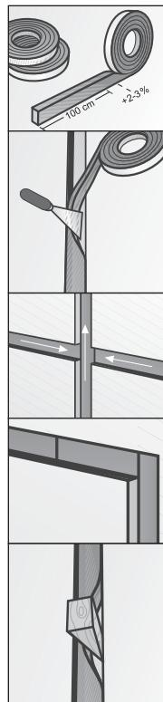
**Fugenvorbehandlung/Untergrund:** Die Untergründe/Pressflächen müssen weitgehend eben sein. Verunreinigungen z.B. Mörtelreste) sind zu entfernen. Die Fugenflanken sollten weitgehend parallel verlaufen (ggf. sind ein Glattstrich und/oder eine Reprofilierung der Fugenflanken (Altbau) erforderlich). Die Vorgaben für die Fugenbreiten dürfen weder über- noch unterschritten werden, dies gilt auch im Bereich von Unebenheiten.
