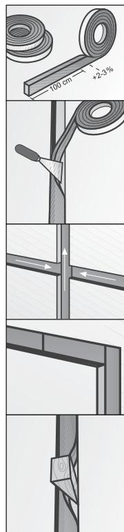
**Предварительная обработка швов и основание:** Основания/поверхности прижима должны быть максимально ровными. Удалить все загрязнения (например, остатки строительного раствора). Кромки швов должны проходить, по возможности, параллельно (при необходимости гладить шов и/или обновить профиль кромки шва (старые здания)). Соблюдать рекомендуемую ширину ленты – не допускать изменений ни в большую, ни в меньшую сторону. То же самое касается и участков с неровными поверхностями.
