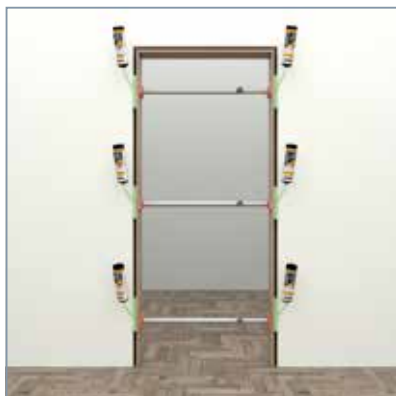
2. Ausschäumen mit zweikomponentigem PU-Schaum.
