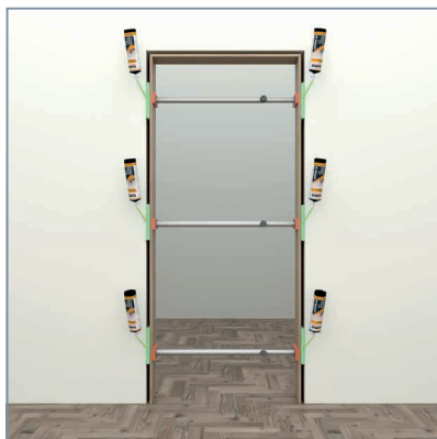
2. Ausschäumen mit zweikomponentigem PU-Schaum.
