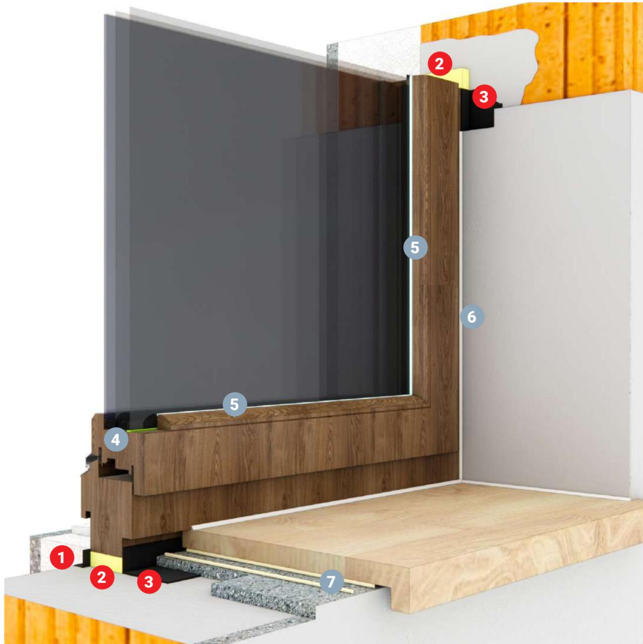
Die 3 Funktionsebenen welche gemäß ÖNORM B5320 und „RAL-Leitfaden zur Planung und Ausführung der Montage von Fenstern und Haustüren“ erfüllt werden müssen
